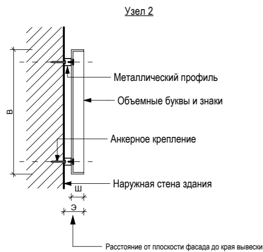
Схема типового крепления настенной информационной конструкции объемные буквы и знаки без подложки
